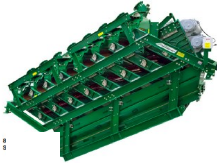
Рис. 1.24. Загальний вигляд грохота Derrick SuperStack®, що має 8 дек.
