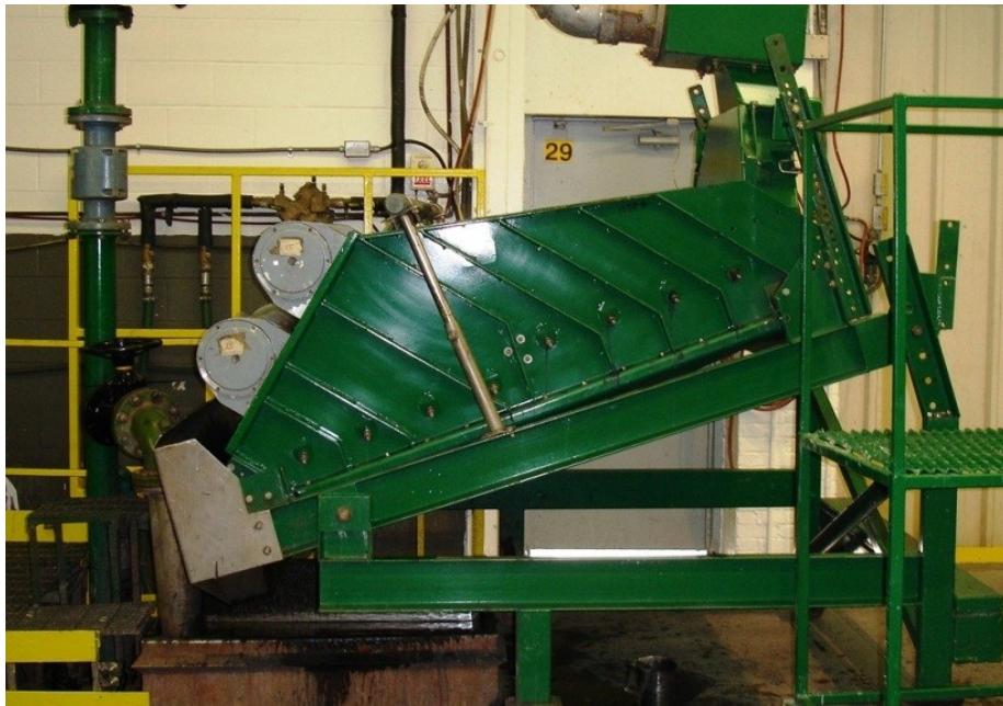
Рисунок 3.5. Однодечний грохот Stack Sizer™
