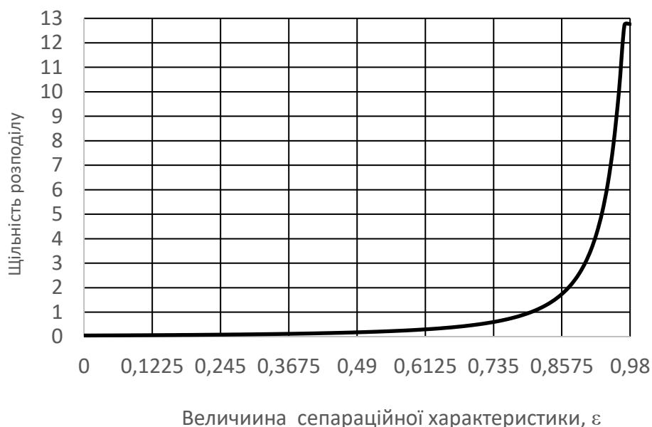
Рис.2.11. Графік щільності розділення сепараційної характеристики підрешітного продукту грохочення згідно (2.100)
