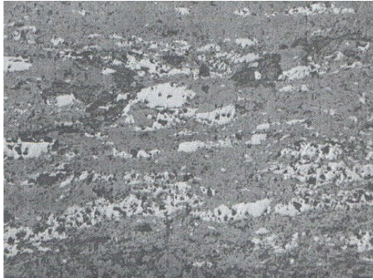
Різновид VII: сіре-магнетит, темно-сіре – кварц, від темно-сірого до чорного – силікати, чорне – пустоти
