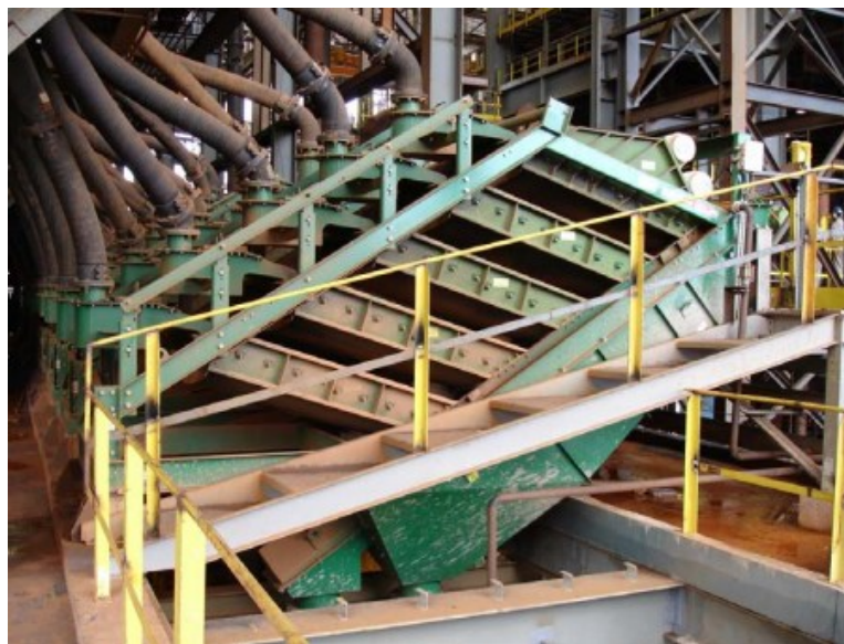
Рис. 1.22. Грохот Derrick Stack Sizer®, що використовується при збагаченні залізних руд у Бразилії.
