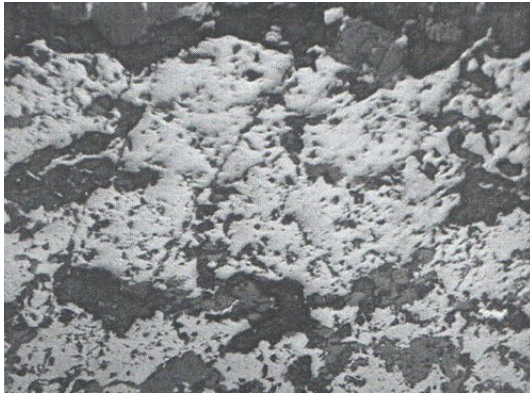
Різновид I: біле – залізна слюда, сіре – магнетит, темно-сіре – кварц, чорне – пустоти
